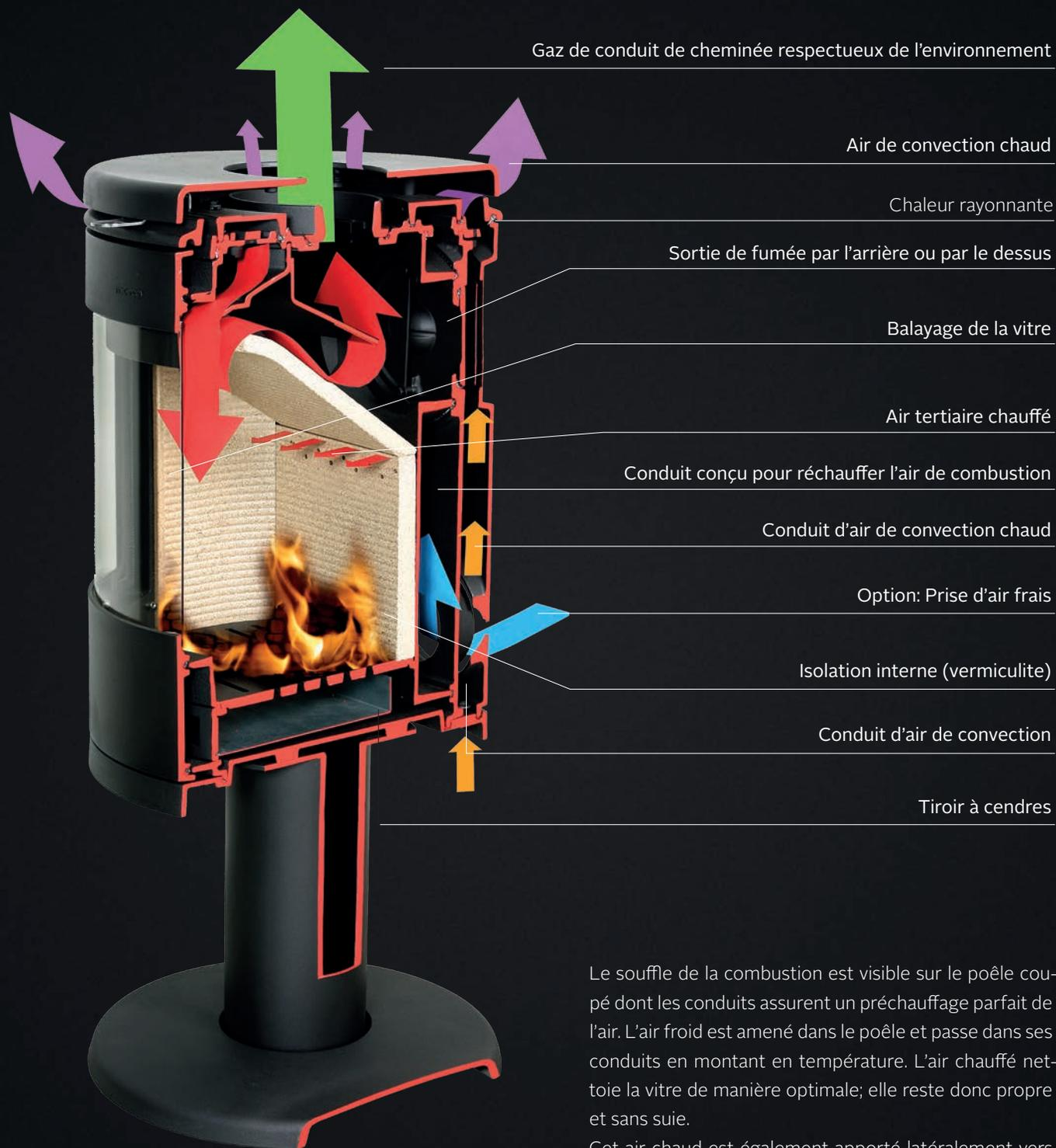
Le souffle de la combustion est visible sur le poêle coupé dont les conduits assurent un préchauffage parfait de l'air. L'air froid est amené dans le poêle et passe dans ses conduits en montant en température. L'air chauffé nettoie la vitre de manière optimale; elle reste donc propre et sans suie.
